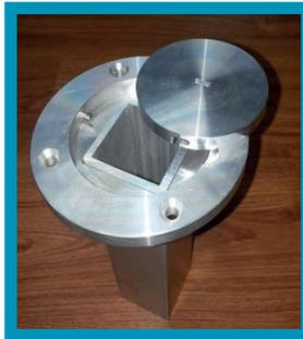
La cubierta para anclaje para poste de bádminton móvil está hecho de perfiles de aluminio resistentes. La sección transversal del soporte inferior mide 40x40 mm y no sobresale en la pista. La altura se puede ajustar en el lugar de instalación fácilmente. Los postes traen con un mecanismo tensor de red. Los soportes están recubiertos al polvo. El artículo no incluye los anclajes.
